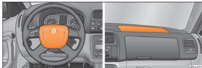
Фиг. 102 Еърбег на шофьора във волана / еърбег на пътника до шофьора в арматурното табло
