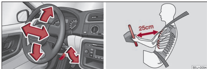
Фиг. 81 Регулираш се волан: лостче под колона на волана / безопасно разстояние от волана
