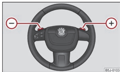
Фиг. 90 Многофункционален волан: ръчно превключване на скоростите
