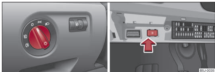
Фиг. 22 Арматурно табло: Превключвател на светлините / отделение за предпазители: превключвател на светлини за осветяване през деня
