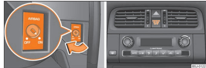
Фиг. 109 изключвател на преден еърбег за пътника до шофьора / контролна светлина за изключен преден еърбег за пътника до шофьора
