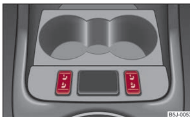
Фиг. 40 Двупозиционен превключвател: Нагряване на предните седалки
