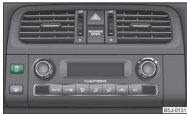
Фиг. 118 Включвател ASR
