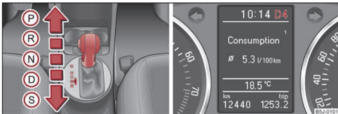
Фиг. 88 Избирателен лост / Информационен дисплей позиции на скоростния лост
