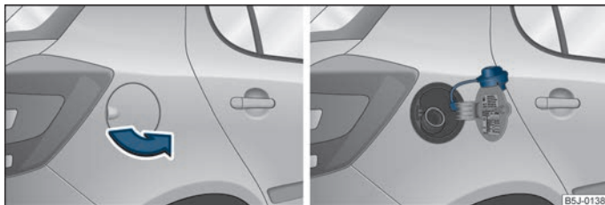
Фиг. 125 Задната странична част на каросерията отдясно: капаче за гърлото на резервоара / капаче за гърлото на резервоара за гориво с отвинтена запушалка
