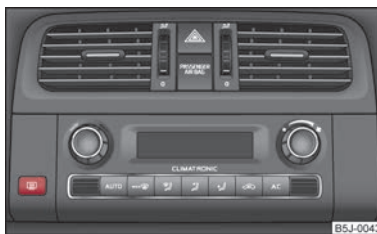
Фиг. 30 Превключвател за нагриване на задното стъкло
