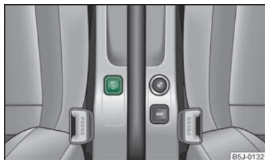
Фиг. 119 Превключвател за настройка на контролното значение на налягането на гумите.
