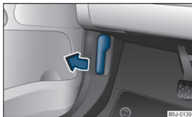
Фиг. 126 Лостче за деблокиране на капака на двигателя
