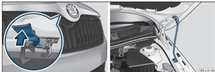
Фиг. 127 Решетка на радиатора: блокиращо устройство с лостче / блокиране на капака на двигателния отсек с помощ на подпорка
