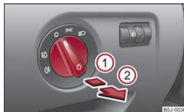
Фиг. 23 Арматурно табло: Превключвател на светлините
