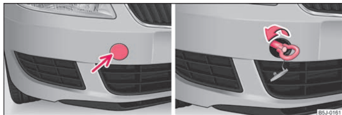
Фиг. 149 Преден амортизьор: Капачка / монтаж на халката за теглене
