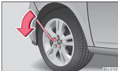
Фиг. 142 Смяна на колело: разхлабване на винтовете
