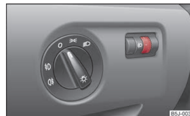
Фиг. 24 Арматурно табло: настройване на наклона на фаровете
