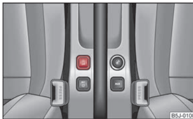
Фиг. 87 Средна конзола: Бутон на системата СТАРТ-СТОП
