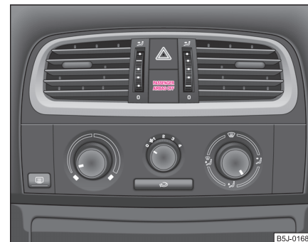
Изобр. 134 Контролна светлина за изключената въздушна възглавница на пътника до шофьора
