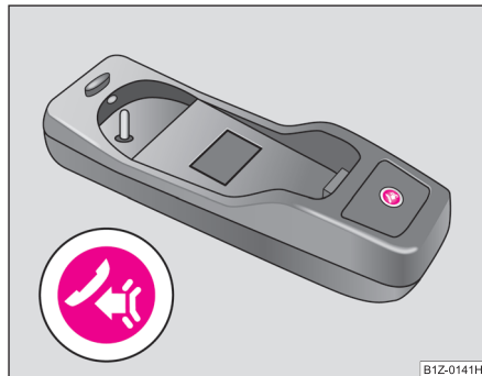
Изобр. 112 Бутон за включване на гласово управление
