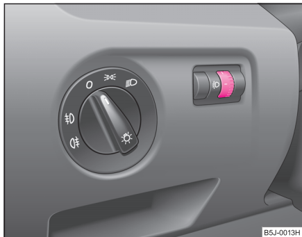
Изобр. 35 Арматурно табло: нагласяване на наклона на фаровете
