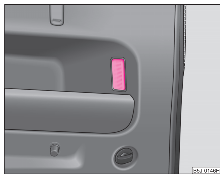
Изобр. 194 Демонтаж на осветление на багажника
