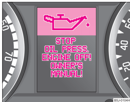
Изобр. 13 Информационен дисплей: ниско налягане на маслото
