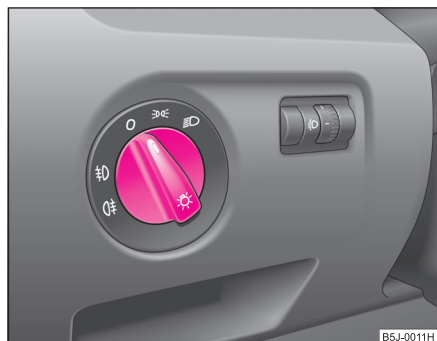
Изобр. 32 Арматурно табло: превключвател на светлините
