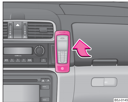
Изобр. 113 Универсална подготовка за инсталиране на телефон
