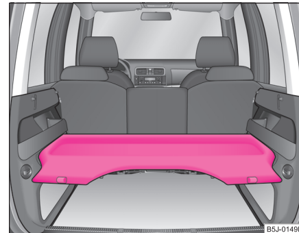
Изобр. 65 Защитен панел на багажника в долна позиция
