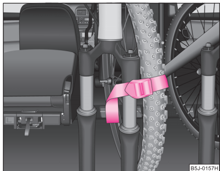
Изобр. 69 Пример за фиксиране на предното колело на велосипед
